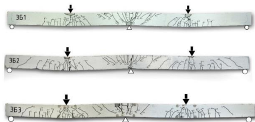
Рис. 3. Характер розвитку тріщин у дослідних балках
