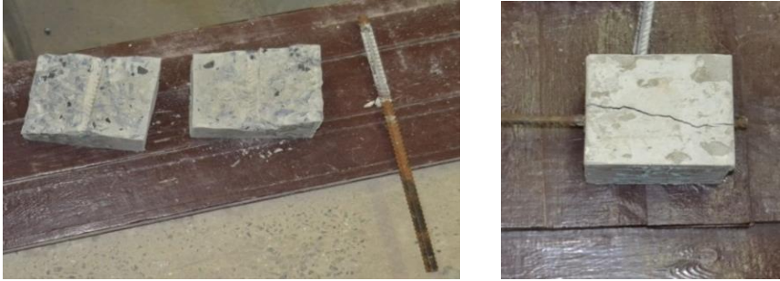
Рис. 3. Характер руйнування зразків
